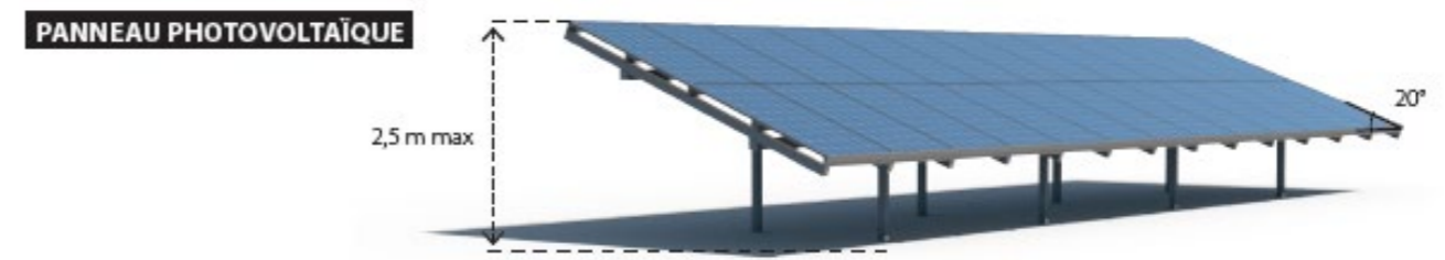
Figure 4: Plan de coupe de la structure fixe (Source : Composite – Paysage et Territoire)
